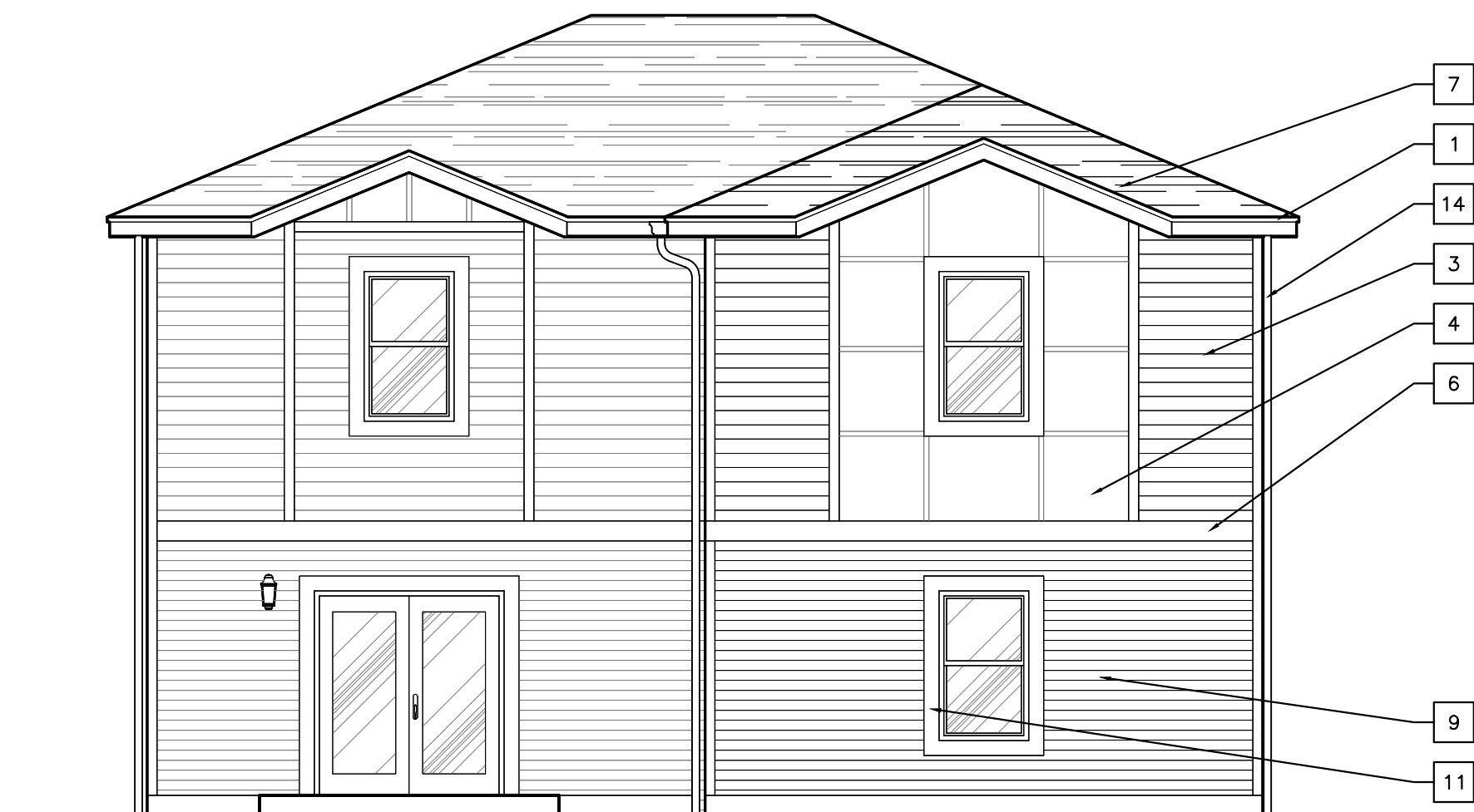
5 DUPLEX BUILDING D1 REAR ELEVATION A2 SCALE: 3/16"=1'-0"
